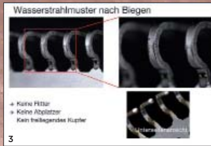
2 Laser-Feinschneiden und Wasserstrahl-Mikropräzisionsschneiden nach Verzinnung
