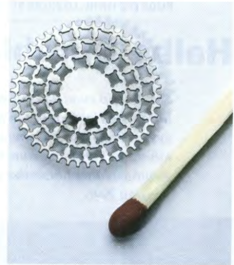
Ein 0,3 mm durchmessender Wasserstrahl schneidet auf \pm 10 \mu\text{m} genau Bilder: DeSta
